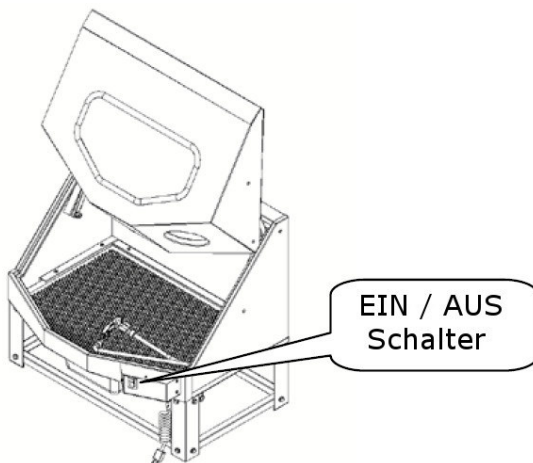
Abb. 7: Einschalten des Teilwaschgerätes TWG 1
