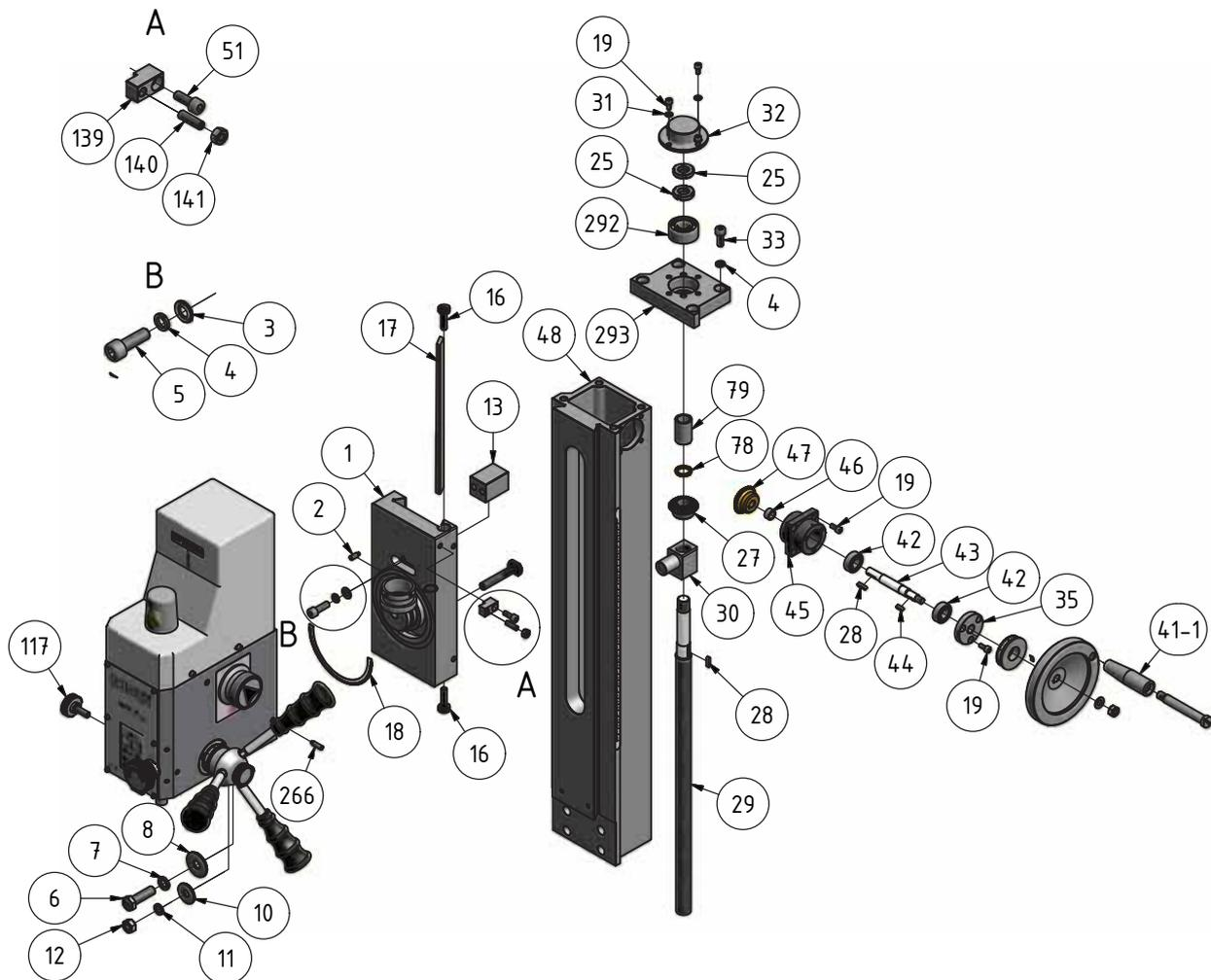
**D Fräskopf 1 von 2 - Milling head 1 of 2**
