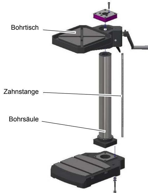
Abb. 3-2: Montage Bohrtisch B24H
