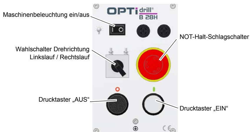
Abb.4-5: Bedienelemente auf dem Bedienfeld B28H
