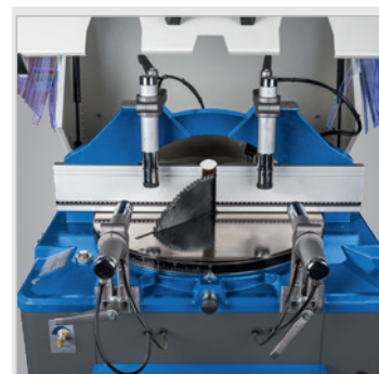
▶ Serienmäßig mit vier pneumatischen Spannzyklindern
