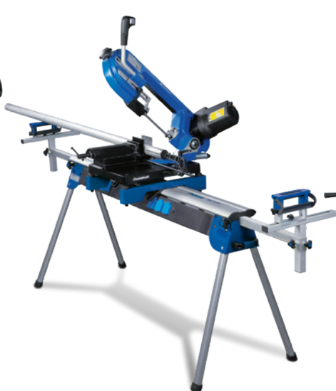
MBS 150 auf Universalwerkstisch UWT 3200 beidseitig stufenlos aus- ziehbare Auflagearme bis 2.400 mm, Tragekapazität bis zu 225 kg
