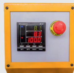
► Bedienpult mit Digitalanzeige und NOT-AUS-Schalter
