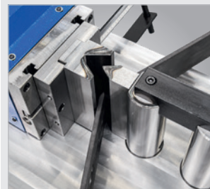
► Mit Schnellwechselaufnahme und Seitenanschlag mit Skala
