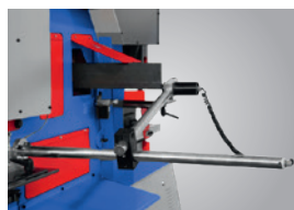
► Elektrischer Kontaktanschlag (serienmäßig ab HPS 55DS)
