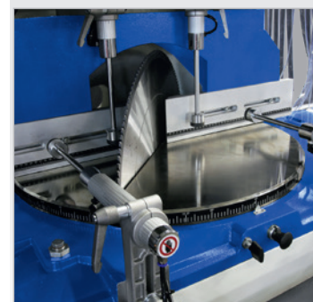
▶ Stufenlose Verstellung des Gehrungswinkels
