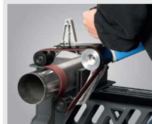
► Nur zwei Arbeitsschritte notwendig für 360° Umfangschleifen
