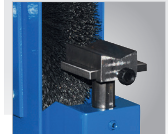
▶ Mit verstellbarer Prismen Werkstückauflage
