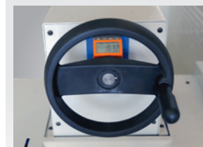
MTBS 2103 F / MTBS 3102 F ▶ Bedienung des Hinteranschlages von der Maschinenfront über Handrad und Zählwerk
