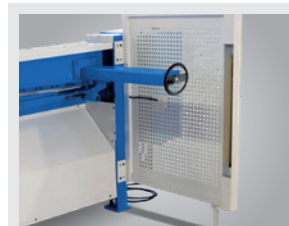
▶ Rückraum durch Lichtschränke abgesichert
