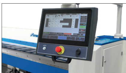
Bedienerfreundliche 15,6" Touchscreen NC-Steuerung an ergonomischen Schwenkarm
