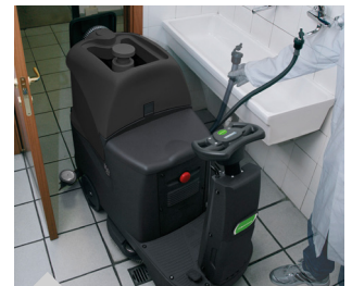
Frischwassertank mit Schlauch für Schnellbefüllung
