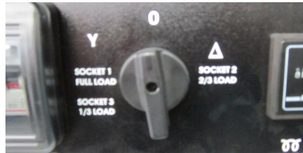
Abb. 15.1: Sternschaltung (rechts) / Dreieckschaltung (links)
