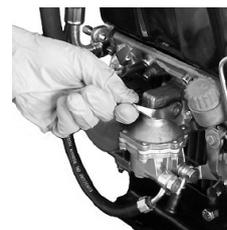
Den Kraftstoff durch manuelle Betätigung des Hebels auf der Kraftstoffpumpe einpumpen.
