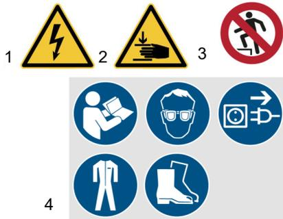
An der Säulen-Werkstattpresse sind Sicherheitskennzeichnungen angebracht (Abb. 1), die beachtet und befolgt werden müssen.
