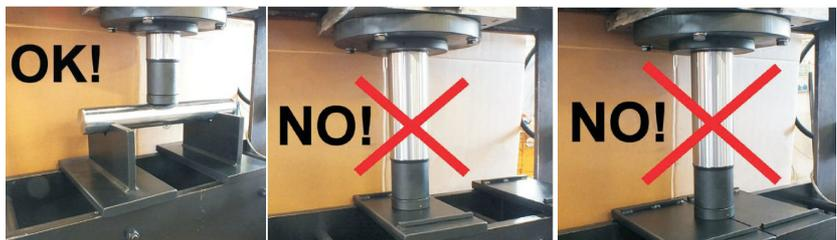
Abb. 11: Werkstück positionieren
