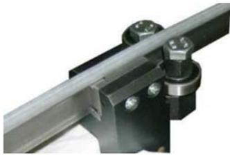
Abb. 44: Sägebandführung
