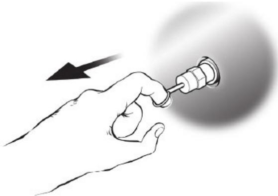
Abb. 12: Sicherheitsventil mit Ring
